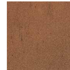
LIGHT RUST ( TMD 52 )
