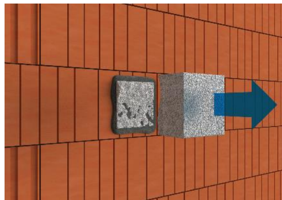
Fot.2 Skúška prídržnosti lepidla k podkladu – odtrhnutie v polystyréne.
