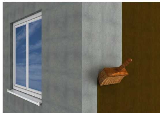
Fot.43 Penetrácia výstužnej vrstvy.
