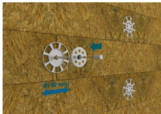
Fot.21 Upevňovanie minerálnej vlny s kolmým vláknom (lamela) s dodatočným tanierom s priemerom 140 mm.
