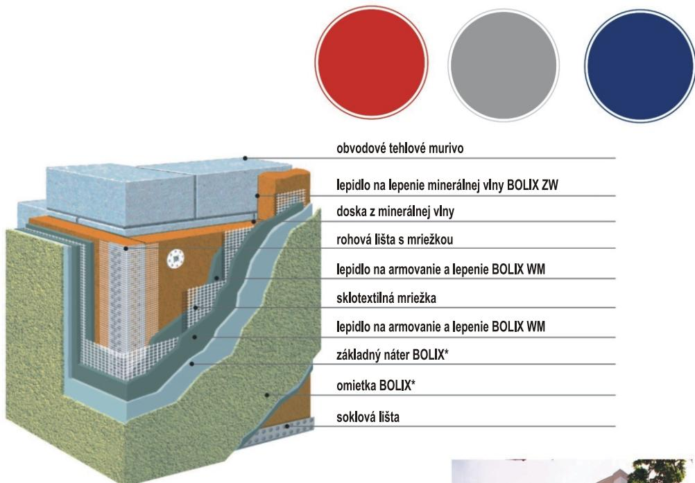
Systémy BOLIX W predstavujú komplexné súpravy materiálov na zateplňovanie rôznych budov (aj tých najvyšších) technológiou kontaktného zateplňovania obvodových múrov budov. Použitie systému spočíva na upevnení dosiek z minerálnej vlny k stene lepiacou maltou a kotvami, vyhotovení vrstvy vystuženej sklotextilnou mriežkou a konečnej povrchovej úpravy tenkovrstvou omietkou.
